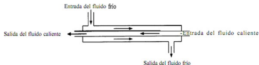
Figura 2.1 Intercambiador de calor de doble tubo a contraflujo (Yunus A. Cengel, 2011)
