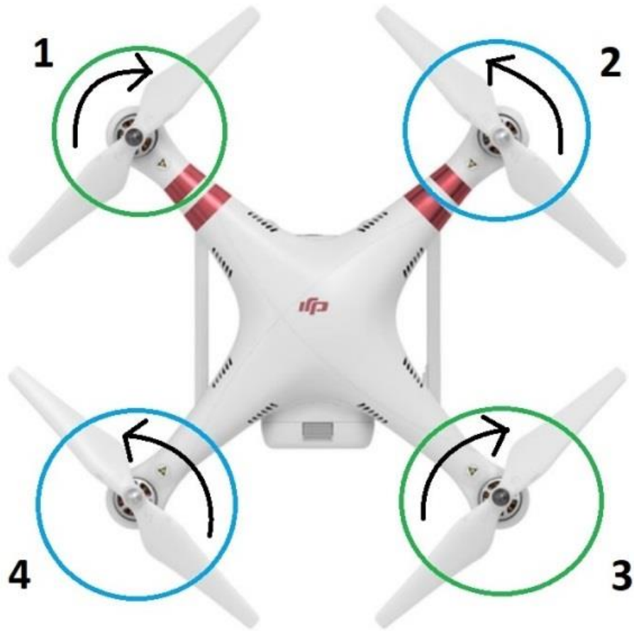
Figura 5.- Dirección de giro de cada una de las hélices del dron cuadricóptero Phantom 3.
