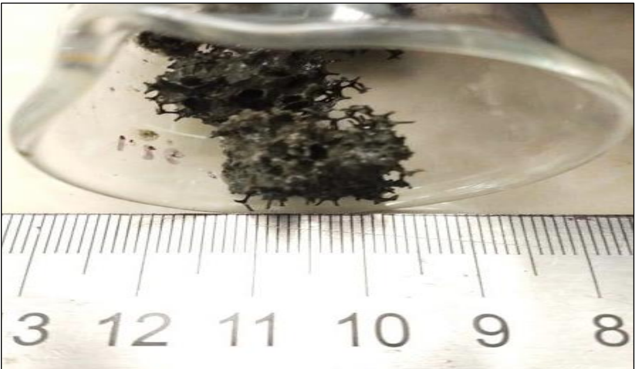
Figura 8. Biomasa fija adherida a un cubo de poliuretano
