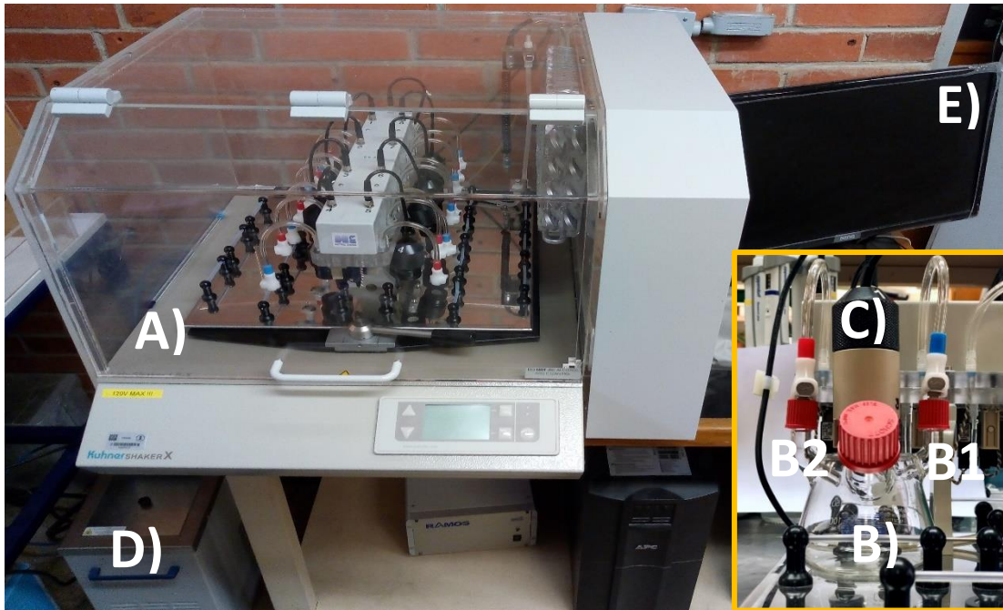
Figura 6.1. Equipo RAMOS, A) Plataforma de agitación, B) Matraz de 250 mL con entrada y salida de gases, C) Sensor galvánico, D) Regulador de temperatura y E) Unidad de control.
