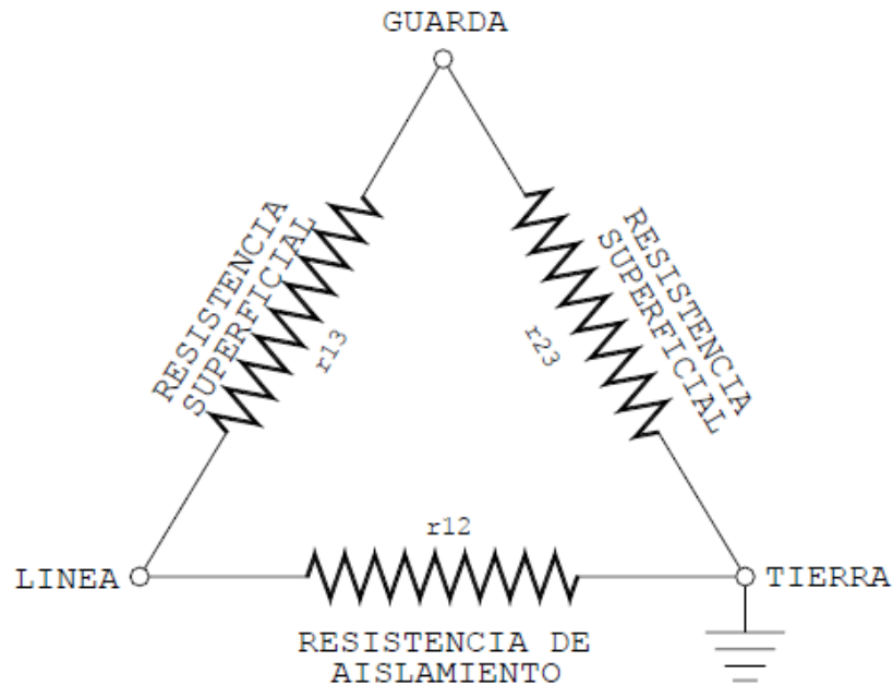
FIGURA 34. Diagrama de resistencias Línea-Guarda-Tierra.
