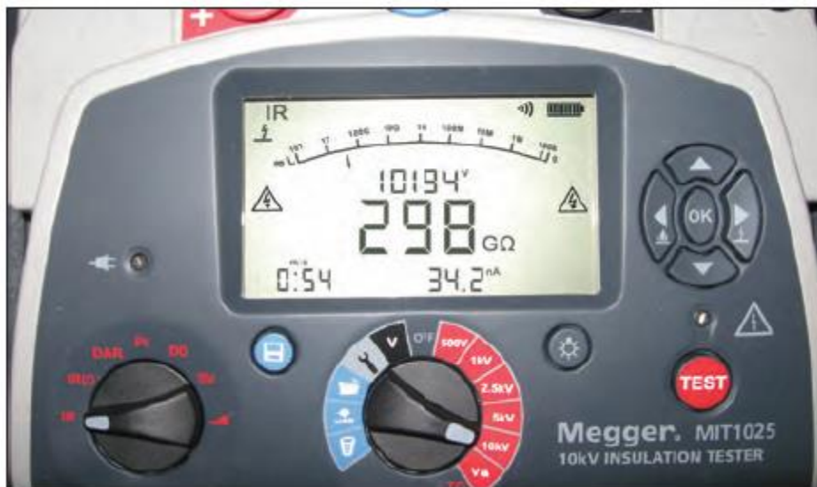
FIGURA 27. Panel superior y pantalla de un MegOhmetro MIT1025 de Megger.
