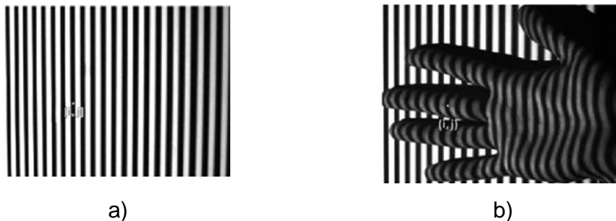
Figura 3.9 Patrón de franjas proyectado en a) un plano de referencia y b) Una mano Humana (Pérez, 2006)
