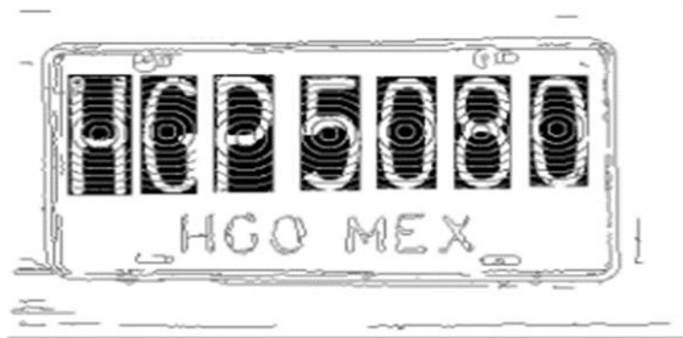
Figura 2.11 Reconocimiento de caracteres en base a su codificación radial. (Sucar y Gomez, 2016)
