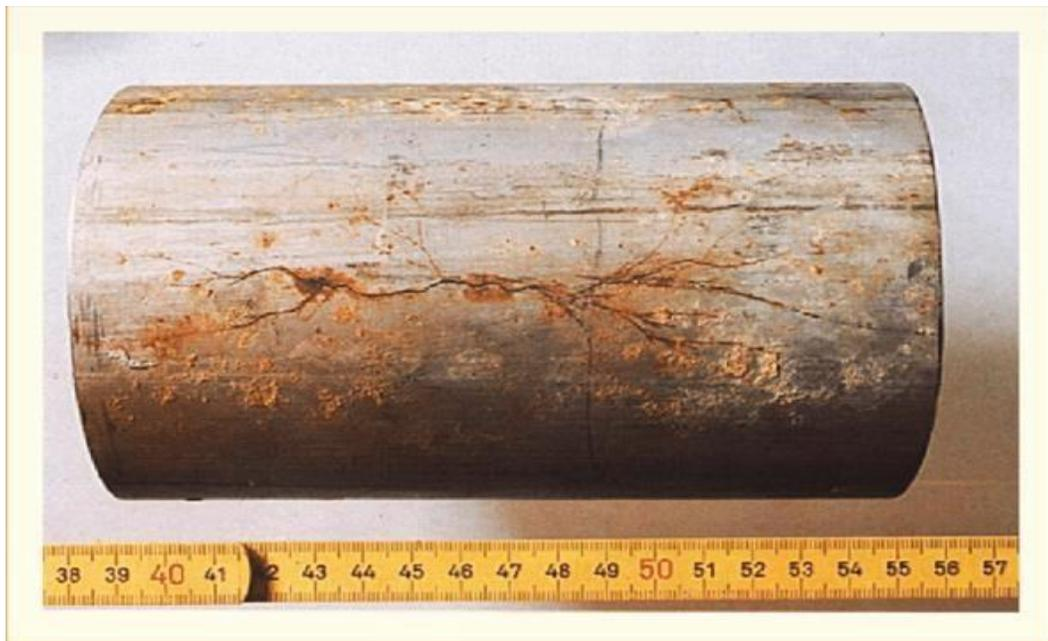
*Figura 1. 4 Corrosión bajo tensión.*
