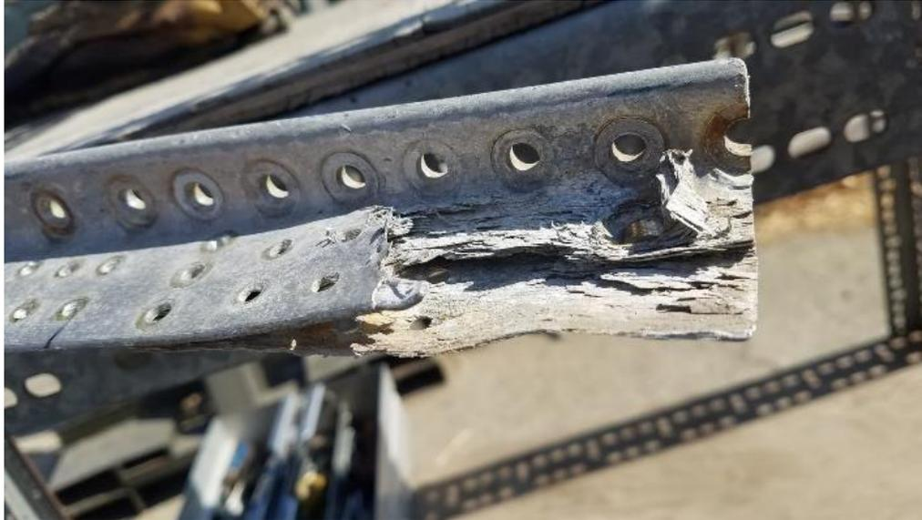
*Figura 1.5 Corrosión intergranular.*
