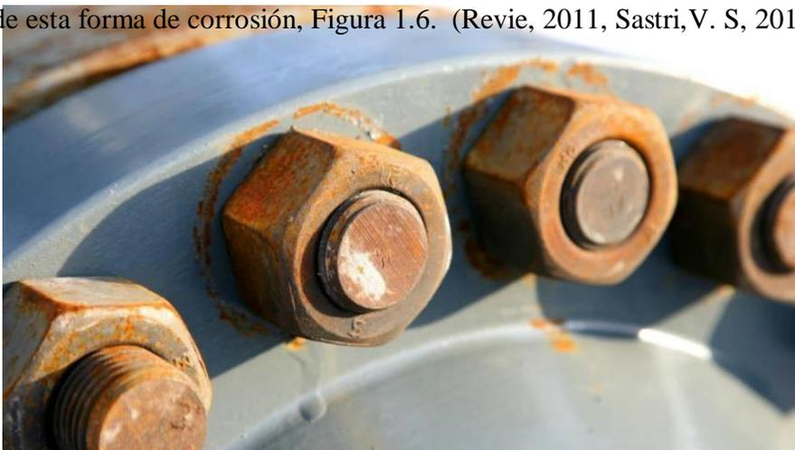
*Figura 1.6 Corrosión galvánica.*
