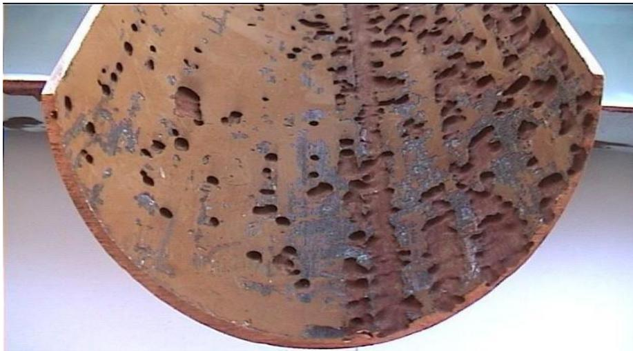
*Figura 1.9 Corrosión por erosión.*
