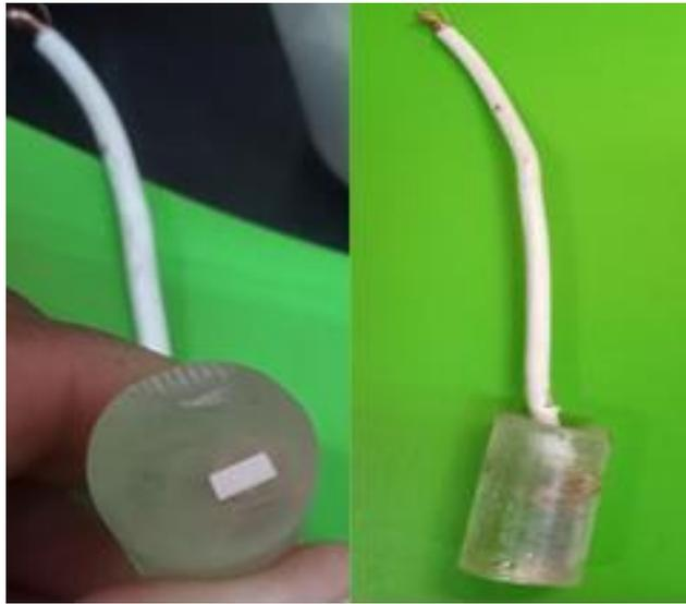
Figura 3.3 Probetas de Aluminio 2024 encapsulada con resina epóxica.
