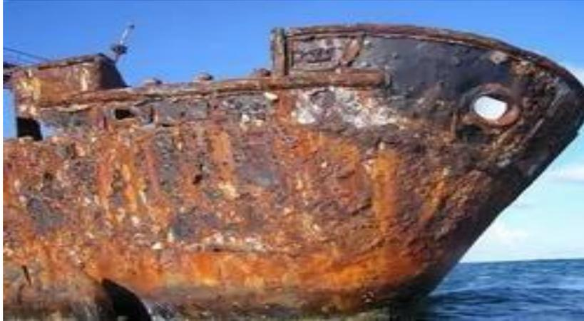
*Figura 1. 2 Corrosión generalizada.*
