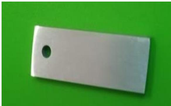
*Figura 3.2 Probeta de Aluminio 2024.*
