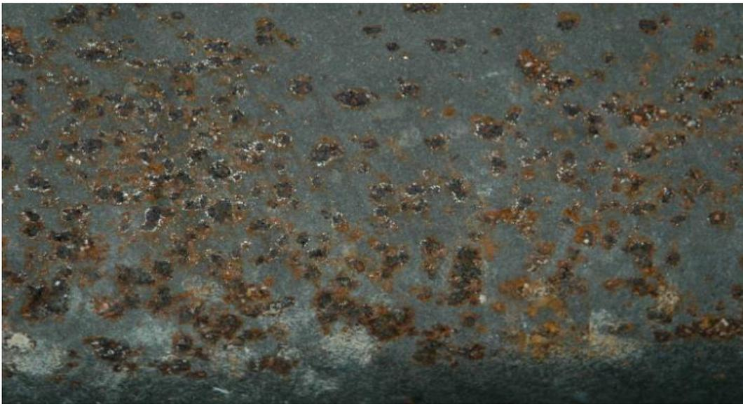
*Figura 1.3 Corrosión por picadura.*
