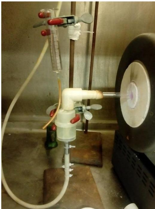
**Figura 3.1** Conexiones del sistema para la pirolisis.
