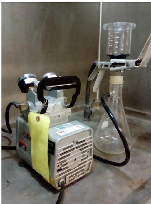
**Figura 3.3** Sistema de filtrado para la recuperación de los MWCNTs purificados.
