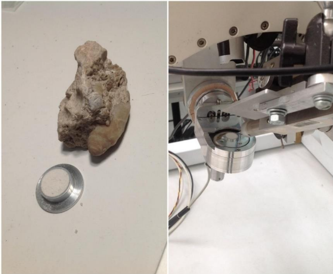
Figura 5. XRD; análisis a muestra en polvo de CPAL.202, gasterópodo; LANCIC, IF-UNAM.
