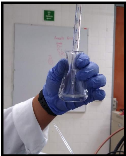
Figura 3.12: Para las muestras tratadas, se colocan 9.0 mL de agua destilada y 1.0 mL de muestra en un matraz Erlenmeyer y se adicionan 0.4 mL de solución bufer.
