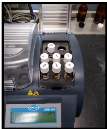
Figura 3.11: Los viales, se colocan en el digestor DRB 200 HACH y se deja por 120 minutos a una temperatura de 150 °C.
