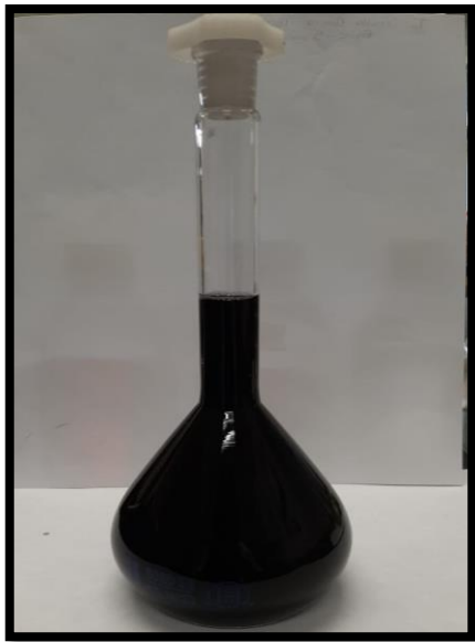
Figura 3.4: Muestra problema solamente con colorante y agua destilada, se afora a 250.0 ml.
