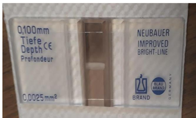
**Figura 6.** Hematocitómetro/cámara de Neubauer para el conteo de conidios de *F. andiyazi*.
