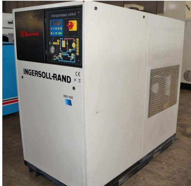
**Figura 39.- Secadora Aire Comprimido**
