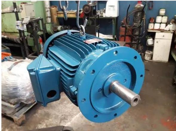
**Figura 41.- Motor ventilador torre de enfriamiento 50 HP**
