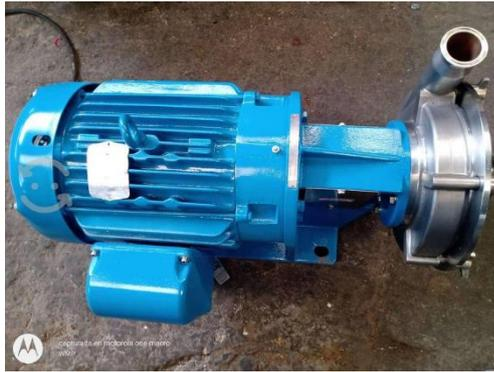
**Figura 29.- Bomba circuito agua clorada 25 HP**
