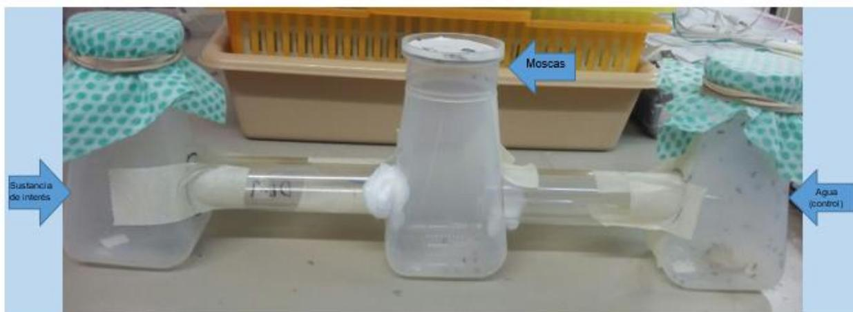
Ilustración 12 Prototipo de laberinto horizontal utilizado para pruebas olfativas. Fotografía: Luz Durán-Mendoza.
