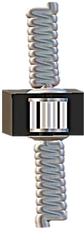
Figura A6. Prototipo de reactor multitubular y tanques de almacenamiento de tubo enroscado acoplados al reactor en la etapa de reducción térmica de \text{CeO}_2 .
