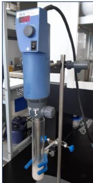
**Figura 11.** Sistema de montaje para la elaboración de NPs de melanina por el método de doble emulsión- evaporación de disolvente.
