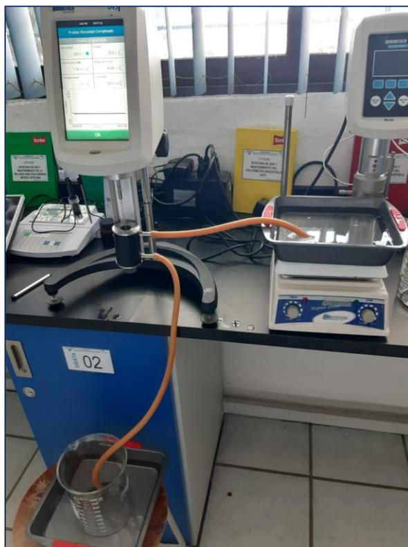
**Figura 13.** Sistema de montaje para la medición de la relación temperatura-viscosidad de geles termosensibles.
