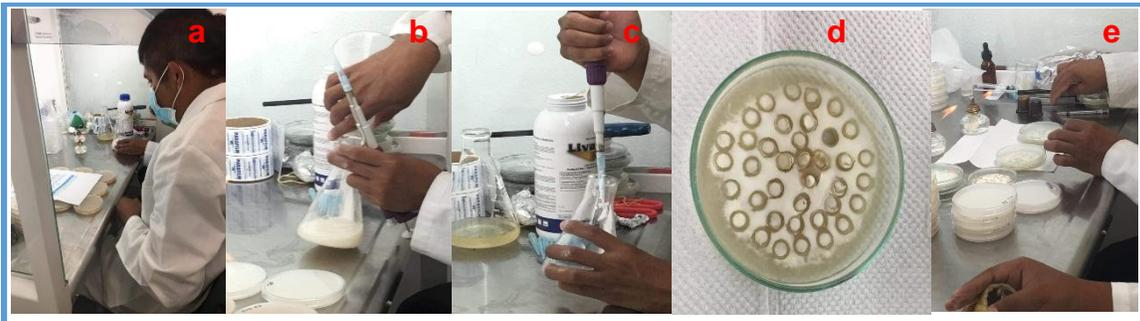
**Figura 5.** Prueba de efectividad *in vitro* con diferentes fungicidas para el control de *Didymella bryoniae*. **a)** Preparación de los fungicidas, peso de las diferentes dosificaciones; **b)** Mezcla de PDA más el fungicida productos en polvo; **c)** Mezcla de PDA más fungicida líquido; **d)** Perforación de los discos de PDA + micelio de la cepa y **e)** Siembra del hongo en los diferentes tratamientos.
