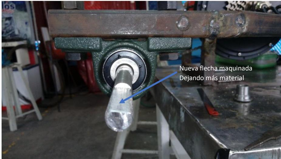
Figura 4.11. Flecha de las llantas traseras maquinado final.
