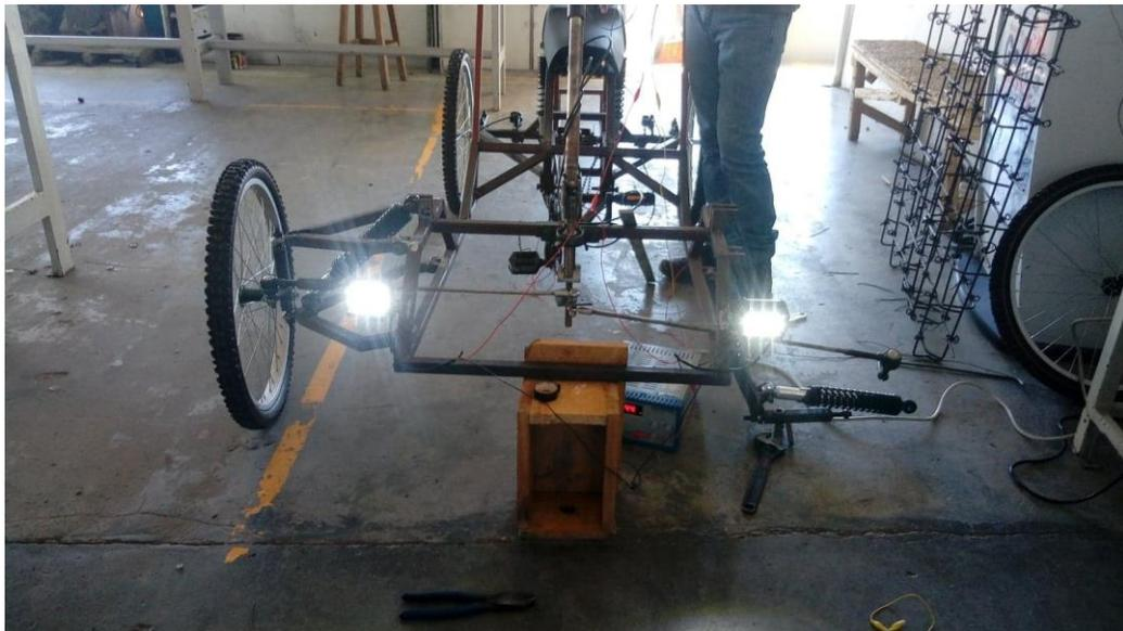
Figura 4.15. Prueba de encendido de los faros.
