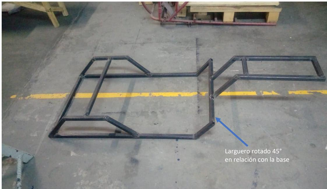
Figura 4.3. Chasis principal, estructura primaria.
