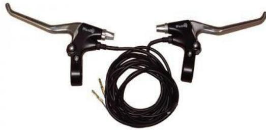
Figura 3.23. Frenos con push botton.
