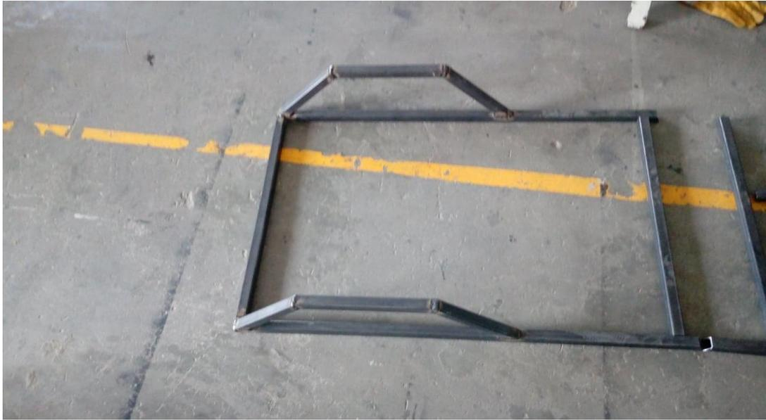
Figura 4.2. Chasis principal en construcción.
