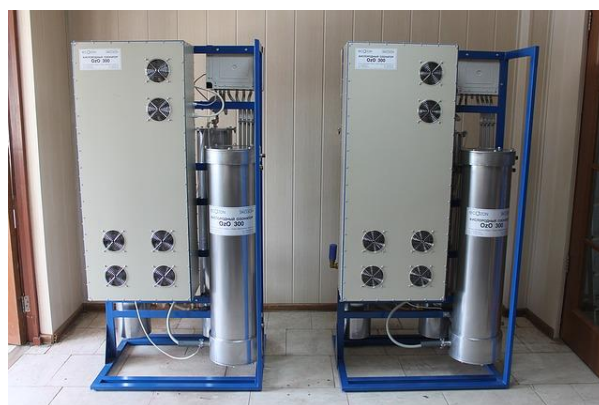
Figura 2.16 Máquinas de ozono utilizadas para tratamiento de aguas residuales.
