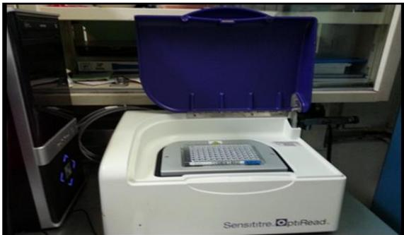
Figura 11. Lector de placas de microtitulación *Sensititre OptiRead*
