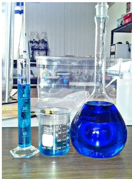
*Figura 24. Solución del colorante Genacryl Blue 3G a 0.3 mM.*
