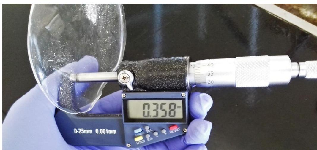
Figura 23. Medición de las películas poliméricas con un micrómetro electrónico.
