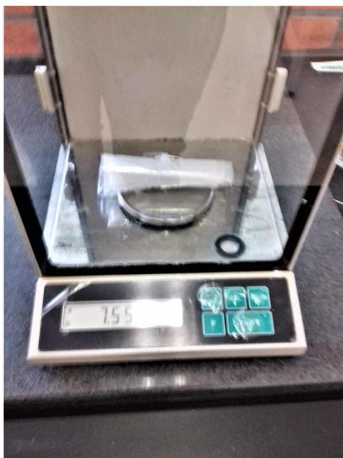
*Figura 20. Bolsas de polietileno siendo pesadas.*
