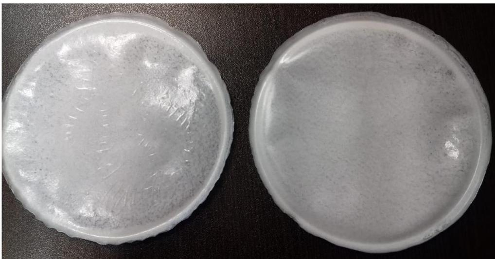
*Figura 31. Películas obtenidas del Policloruro de vinilo.*
