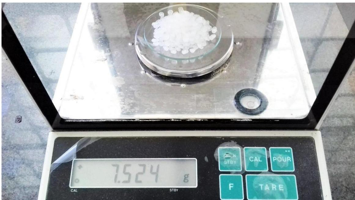
*Figura 19. Polipropileno siendo pesado.*
