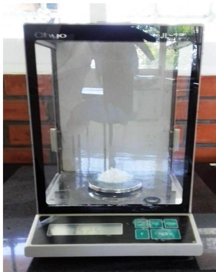
*Figura 6. Balanza analítica CHYO, modelo JL-180*
