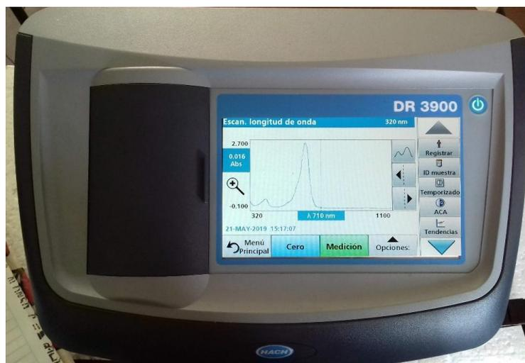
Figura 17. Espectrofotómetro HACH DR 3900.
