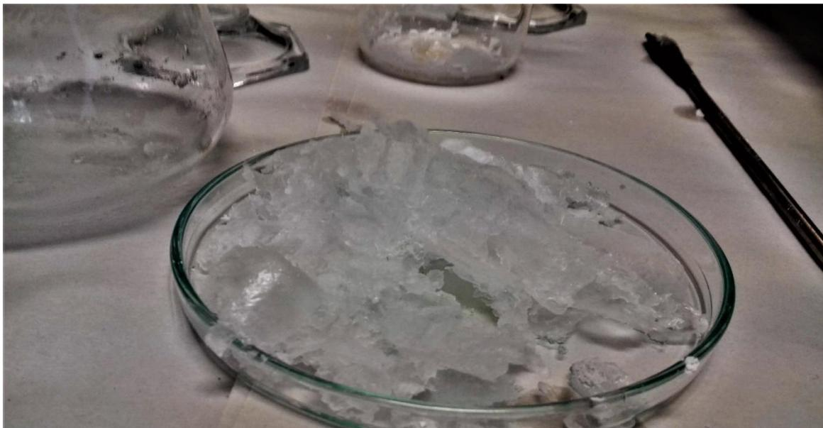
*Figura 27. Polipropileno gelificado remanente.*
