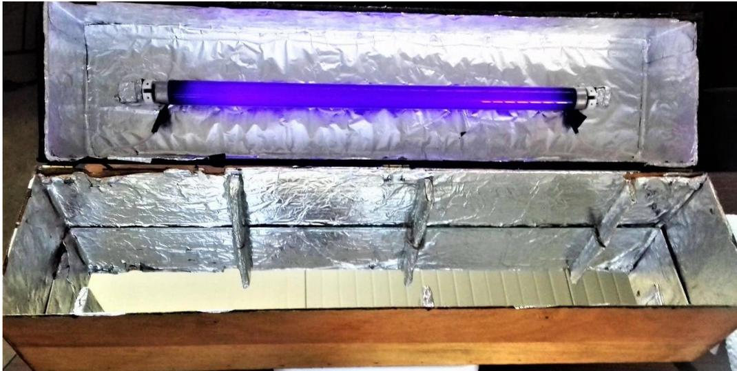
Figura 16. Contenedor con lámpara UV.
