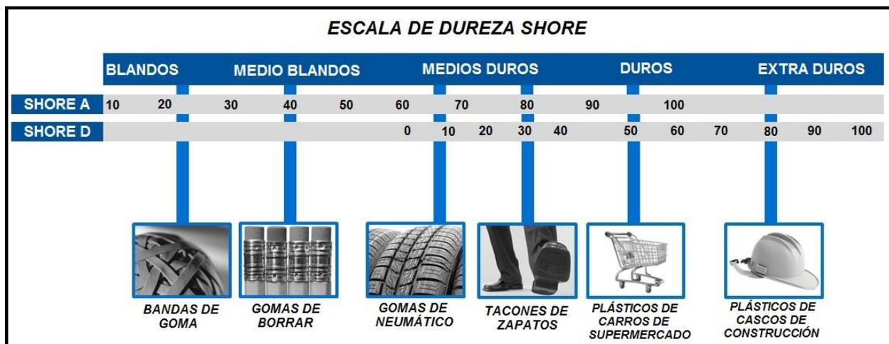
Figura 5. Escala de dureza Shore. Fuente: <https://www.demaquinasyherramientas.com/herramientas-de-medicion/durometro-tipos>
