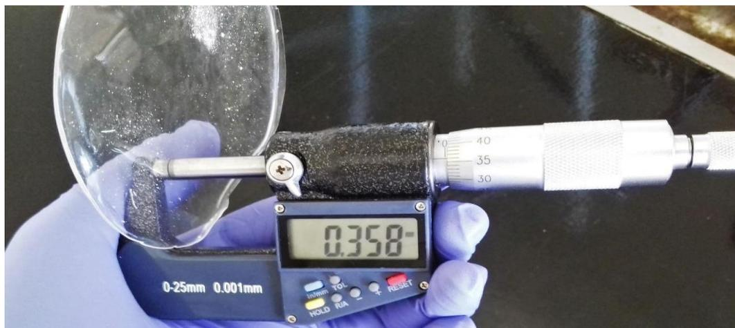
Figura 12. Micrómetro electrónico digital.
