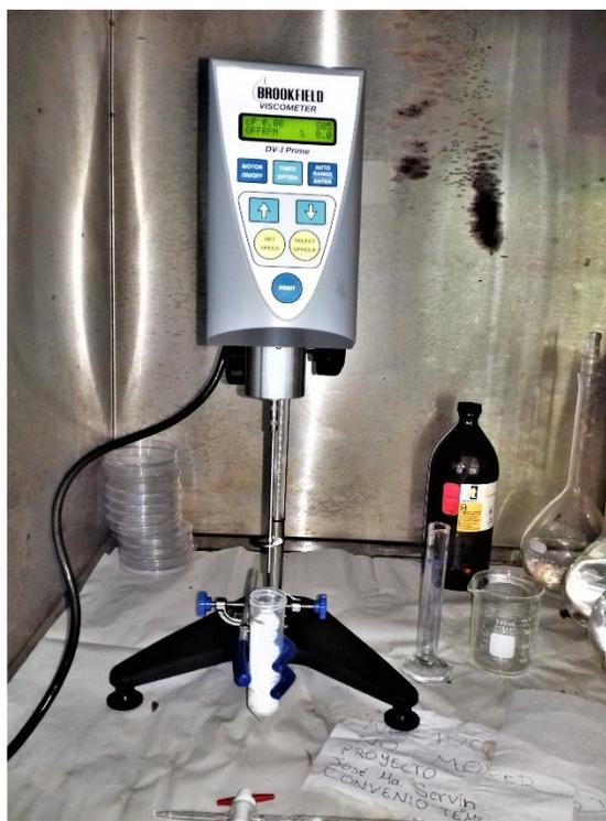
Figura 13. Viscosímetro DV-Prime.
