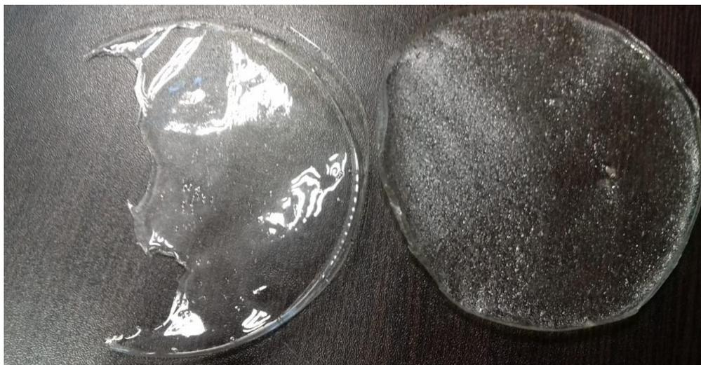
*Figura 32. Películas obtenidas del Alcohol polivinílico.*
