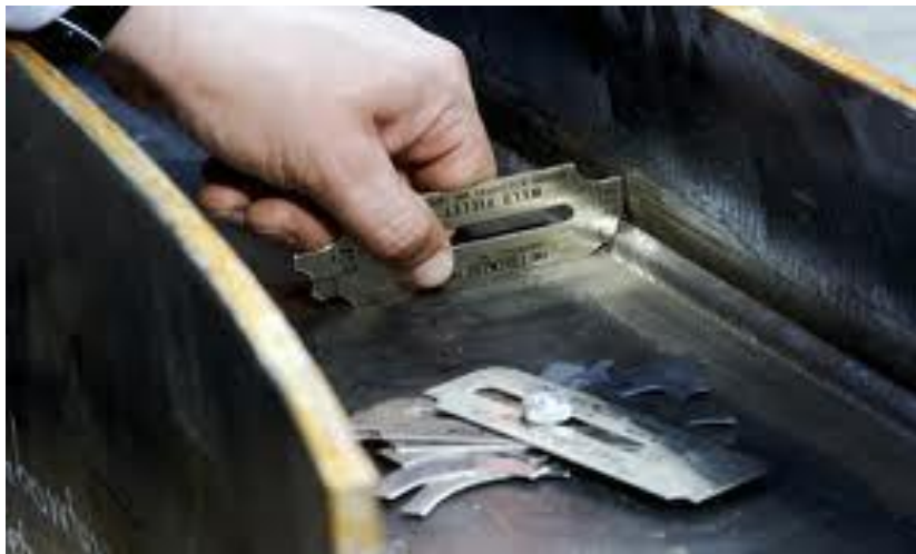
Figura 1. Verificación dimensional de una soldadura.
