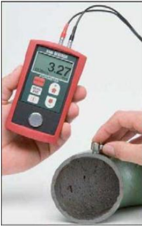
Figura 2. Medición de espesores.
