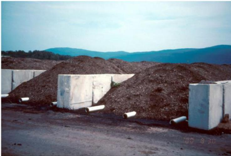
Figura I.4 Pila estática con aireación pasiva tomada del estudio sobre la maquinaria idónea para las labores de compostaje de alperujos de la junta de Andalucía 2016
