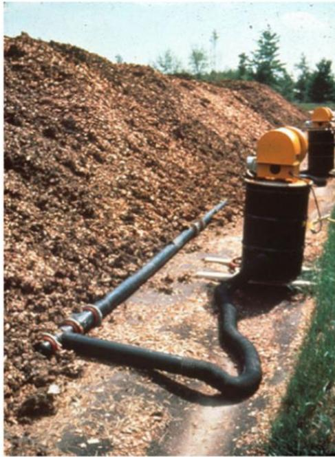
Figura I.5 Detalle de pila estática con aireación forzada tomada del Manual de compostaje de la Junta de Andalucía 2016
