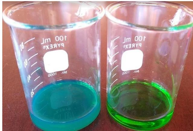
**Figura 3.6** Comparación de absorbancia de la tinta convencional y experimental.
