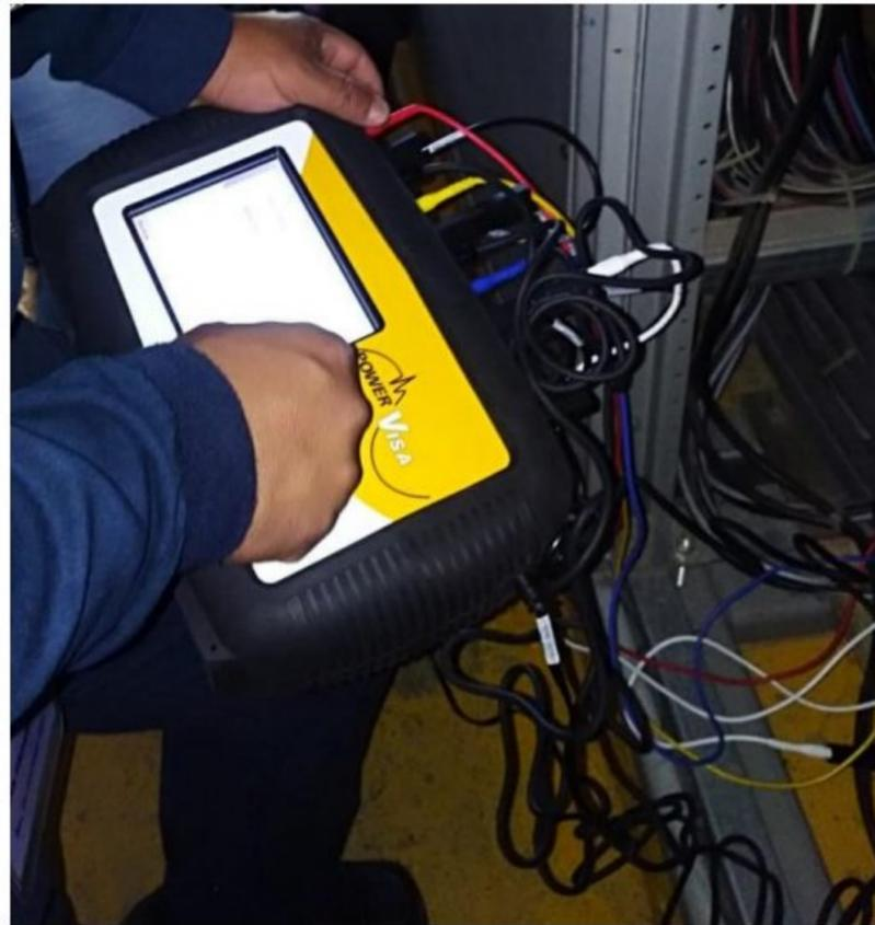
*Figura 4.2. Analizador de redes Dranetz conectado a los sensores de voltaje y corriente.*
