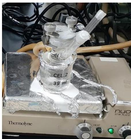
**Figura 27.** Célula de difusión de Franz acondicionada con una solución receptora de Etanol:Agua (70:30)
