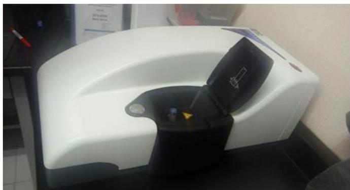
**Figura 25.** Equipo utilizado para determinar el tamaño de gotícula de las **NEs** formuladas
