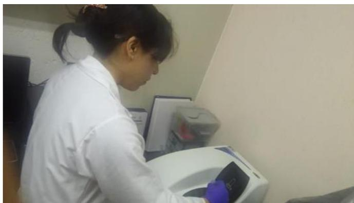
**Figura 26.** Se colocaron cada una de las muestras en la celda para su posterior medición en el equipo Zetasizer HSA 3000
