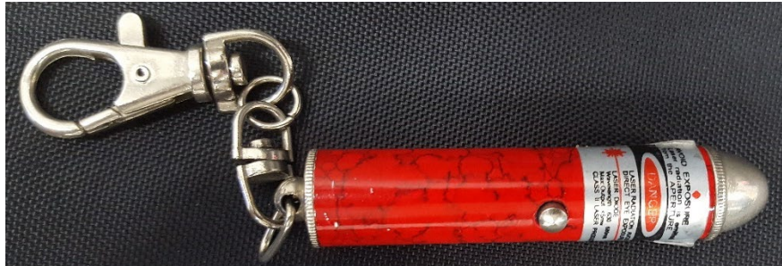
Figura 40. Láser utilizado para el análisis del efecto Tyndall en las dispersiones de ionómero.
