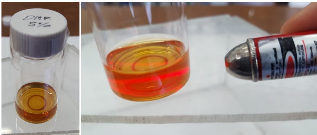
Figura 58. Dispersión de ionómero con DMF presentando el efecto Tyndall después de más de 43 días de almacenamiento.
