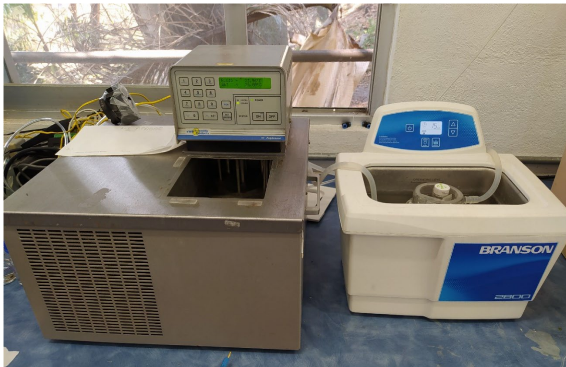
Figura 34. Arreglo experimental para la homogenización de la tinta catalítica.
