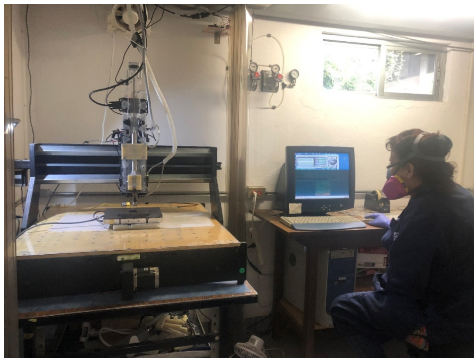
Figura 36. Sistema automático de inyección de tinta utilizado para la fabricación de los GDE anódicos.
