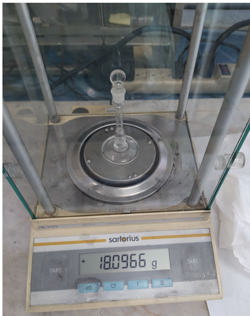
Figura 29. Balanza analítica Sartorius BL 210 S y matraz aforado Pyrex de 1 mL.
