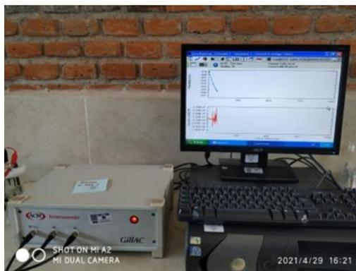
Figura 3.6 Potenciostato Gill AC
