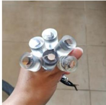
*Figura 3.4 Probetas lijadas a espejo*
