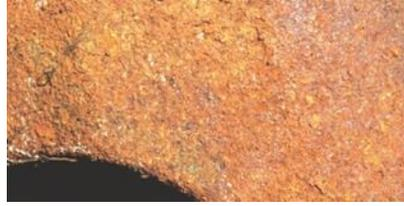
*Figura 2.17 Corrosión uniforme.*
