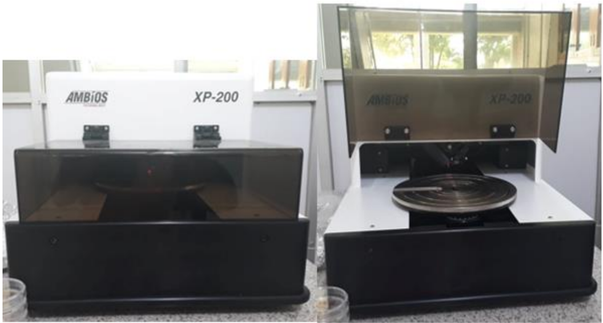
Figura 60 Perfilómetro AMBIOS XP-200
