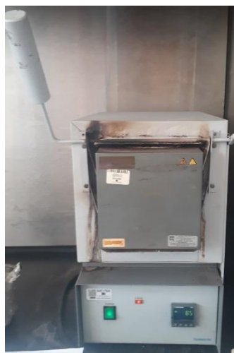
Figura 44 Mufla utilizada para el tratamiento térmico de \text{Co}(\text{OH})_2
