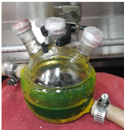
Figura 48 síntesis in-situ con partículas de CoO
