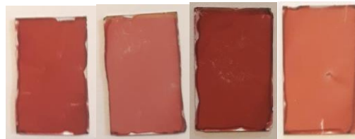
Figura 58 Películas de P3HT, P3HT-CoO 3%, P3HT-CoO 5% y P3HT-CoO 8%
