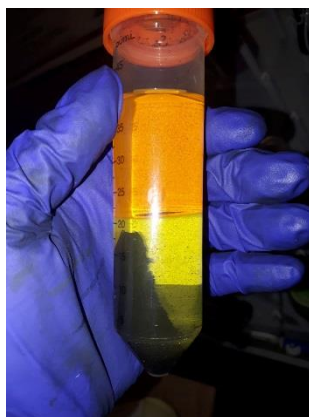
Figura 40 Tubo de centrifuga con polímero y 45 ml de Hexano
