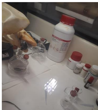
Figura 33 Pesado de \text{FeCl}_3 en cámara de guantes
