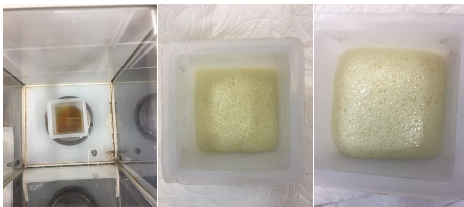
Figura 27. Espuma B- a) pesado de componentes mezcla A-B b) mezcla despues de agitación c) Espuma.
