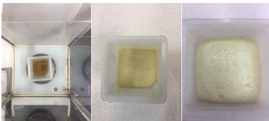
Figura 26. Espuma A- a) pesado de componentes mezcla A-B b) mezcla despues de agitación c) Espuma.
