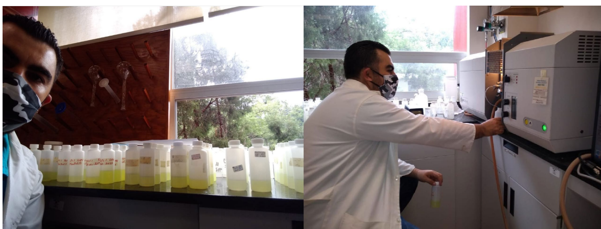
Figura 10. Cuantificación de metales pesados en el espectrofotómetro de absorción atómica
