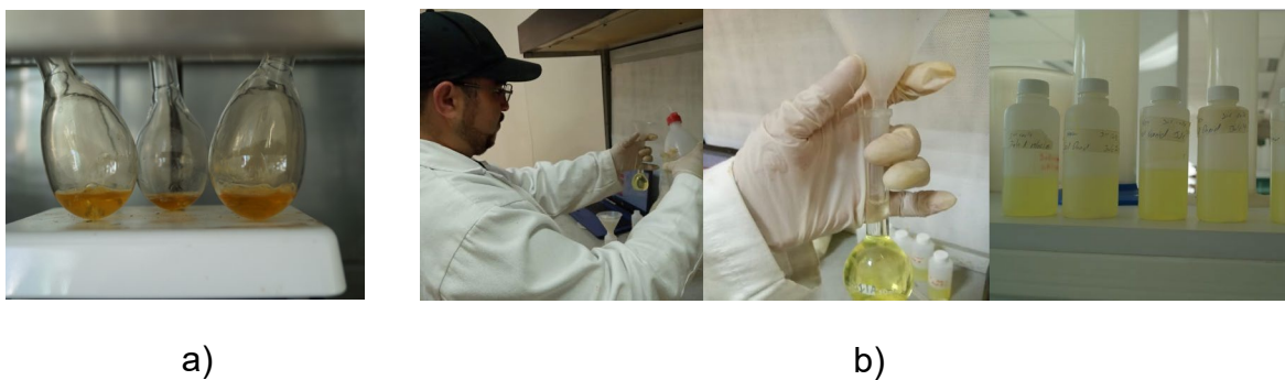
Figura 9. a) Digestion de la muestra con ácido nítrico, b) Aforo con agua destilada a 50 ml.
