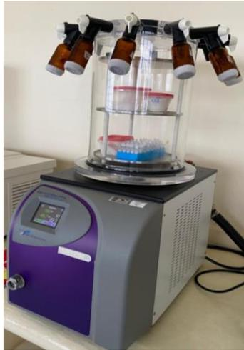
**Figura 9.** Formulaciones sometidas a proceso de liofilización (BenchTop Pro)
