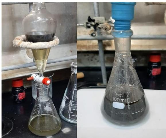
**Figura 30.** Separación de fases de la reacción de síntesis del fenil-pirrol (izquierda) y agitación de la fase orgánica con sulfato de potasio (derecha).
