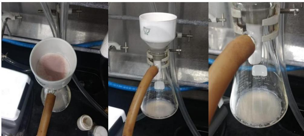
**Figura 31.** Filtrado a vacío de la mezcla de reacción.
