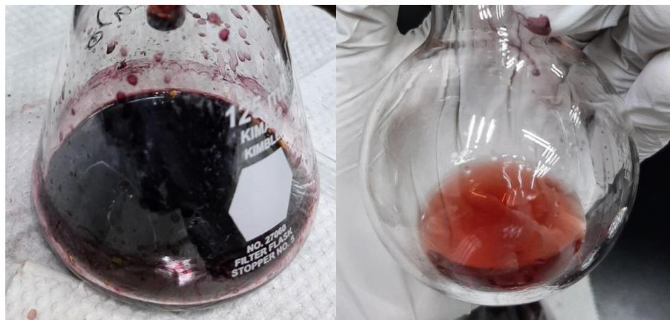
**Figura 38.** Solución obtenida después de filtrar por tapón de sílica gel con sistema diclorometano/trietilamina (99:1) (izquierda), después se filtra con metanol frío y se obtiene la solución color rojo-naranja (derecha).
