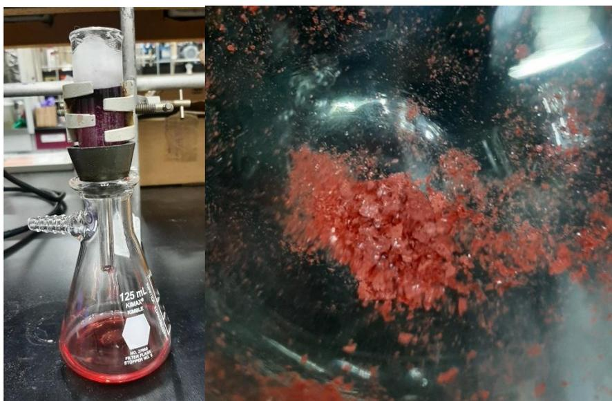
**Figura 36.** Filtración de la mezcla (izquierda) y el producto después de secar en vacío la solución (derecha).
