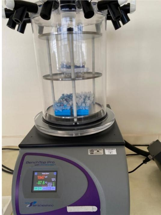
**Figura 13.** Equipo de liofilización para elección del agente crioprotector
