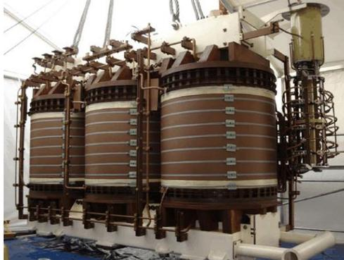
Figura 2.6 Devanados De Un Transformador De Potencia
