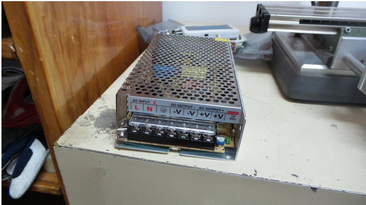
Figura 57. Fuente de alimentación para la placa y los motores NEMA 17.
