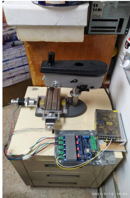
Figura 68. Ensamblado final de los componentes electrónicos tarjeta, fuente de poder y motores.
