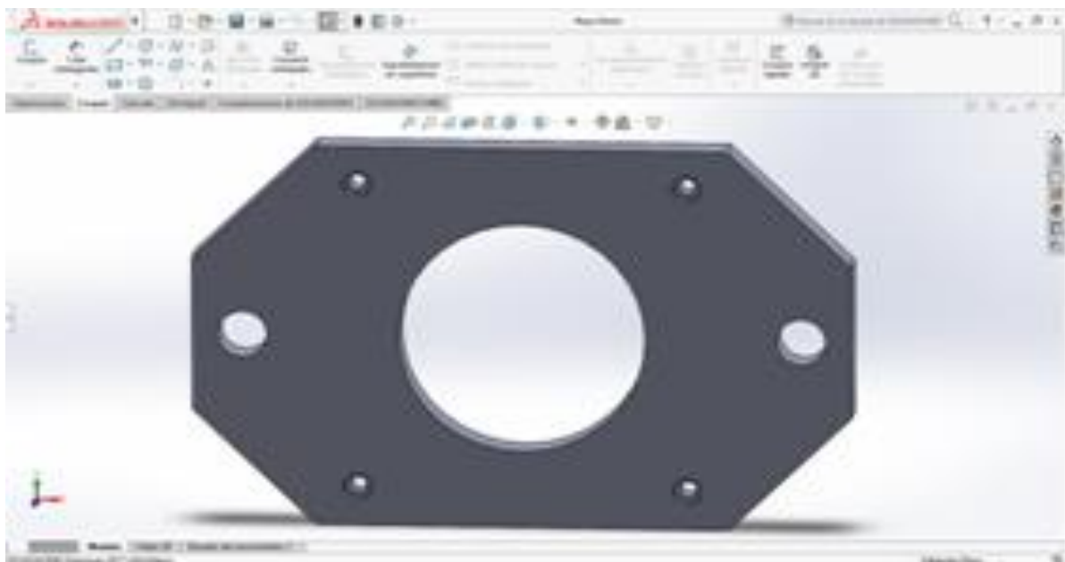
Figura 13. Diagrama de la pieza para el sostén del motor que se conecta con las placas anteriores.
