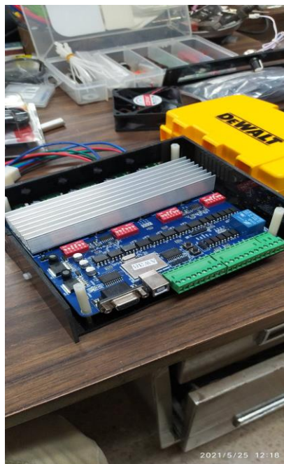
Figura 69. Armado de una caja para montar y proteger la tarjeta de control.
