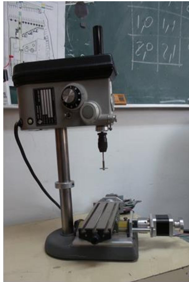
Figura 64. Prueba de montaje de los motores en la mesa X, Y. (Continúa en la siguiente página)
