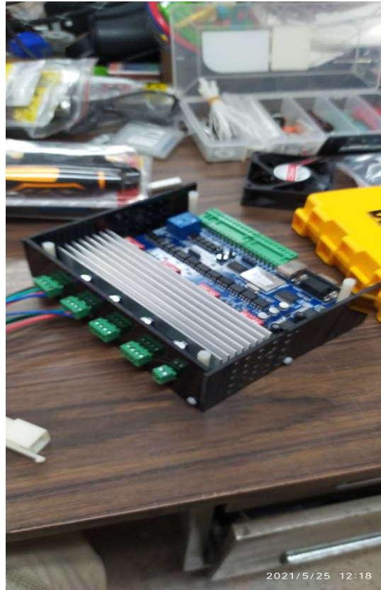
Figura 70. Ranuras para los conectores de control de los motores y alimentación.
