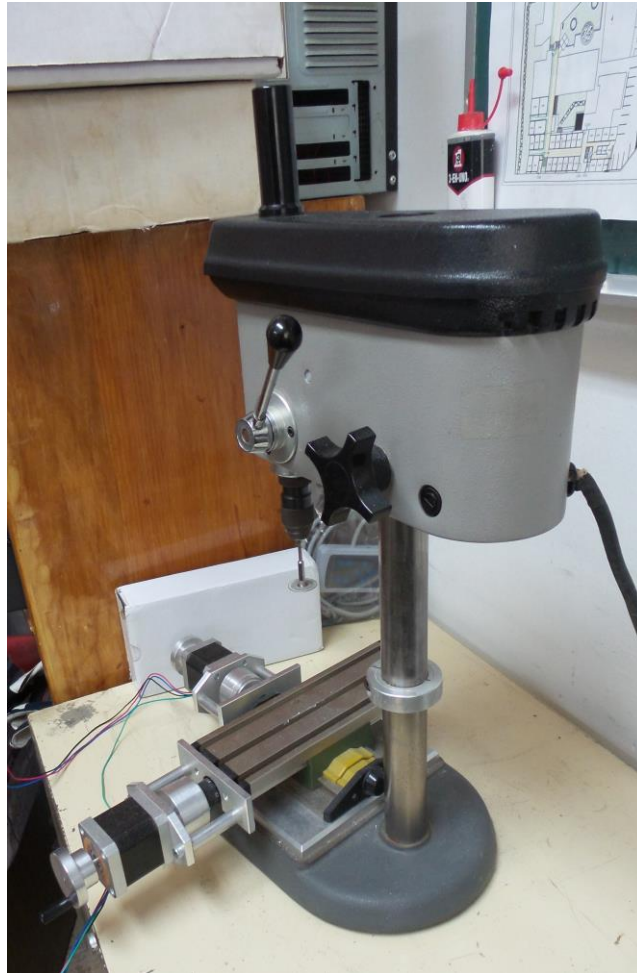
Figura 65. Prueba de montaje de los motores en la mesa XY. (Continúa de la página anterior)
