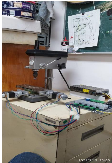
Figura 67. Ensamblado final de los componentes electrónicos a los motores.
