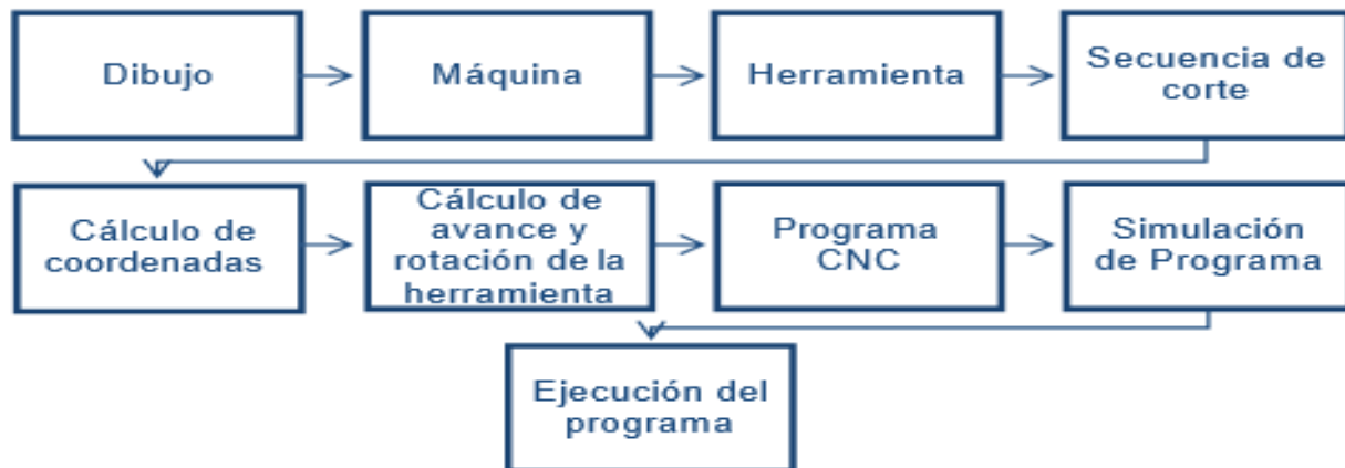
Figura 2. Secuencia del mecanizado CNC.
