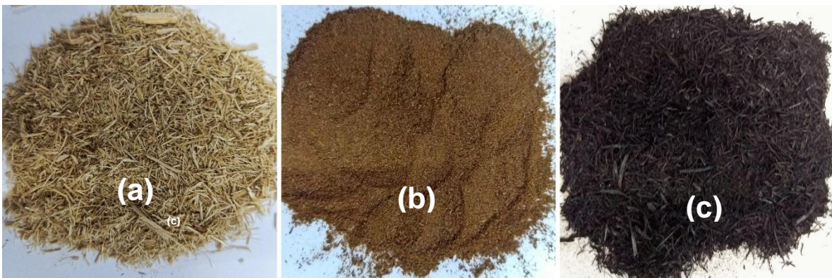
Figura 11 -Cambio de la coloración observado posterior al tratamiento térmico (a) Sin tratamiento, (b) a 200 °C y (c) a 250 °C)
