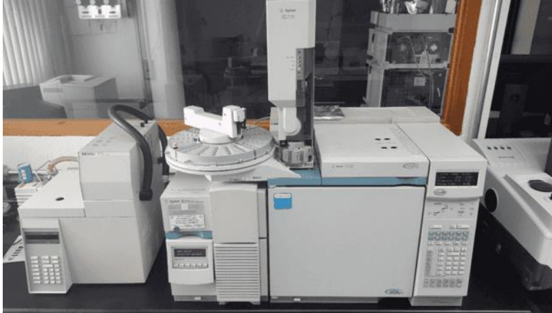
Figura 7 - Cromatógrafo de Gases Agilent Technology 6890 acoplado a un detector de masas 5973N ubicado en LANEM CIQ UAEM
