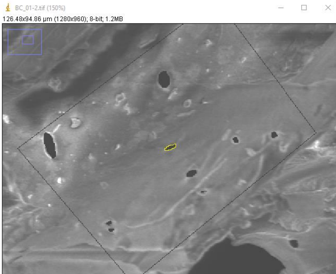
Figura 12 - Procesamiento de la micrografía para la fibra sin tratamiento usando ImageJ.
