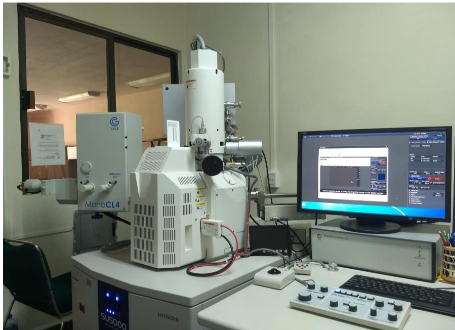
Figura 5 - Equipo de FESEM Hitachi SU5000 Schottky del laboratorio de microscopía electrónica de barrido ubicado en el CIICAP UAEM
