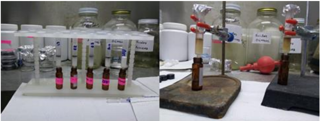
Figura 14 - elución empleando 3 ml de \text{CH}_2\text{Cl}_2
