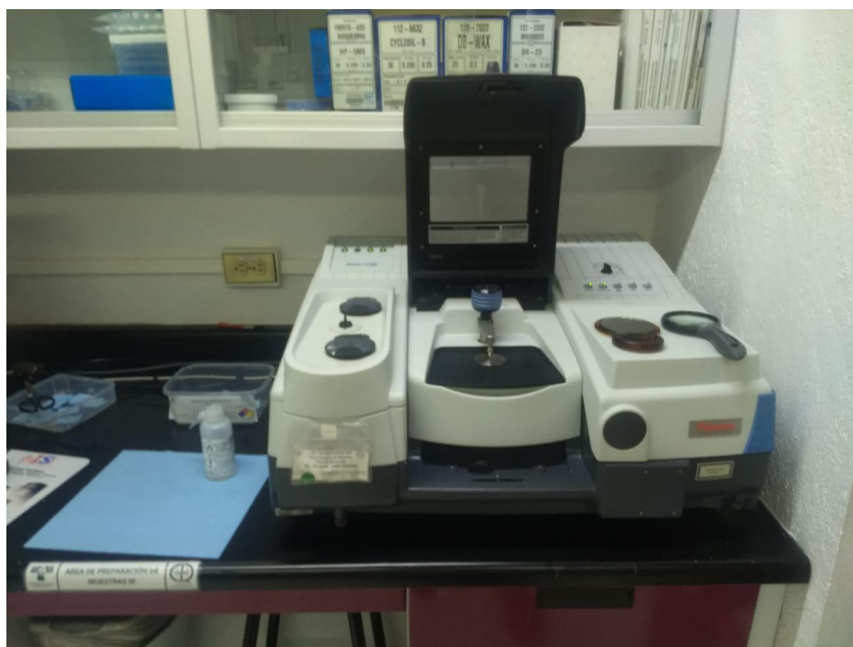
Figura 6 - Equipo de espectroscopía infrarroja de transformada de Fourier NICOLET 6700. – Ubicado en LANEM CIQ UAEM
