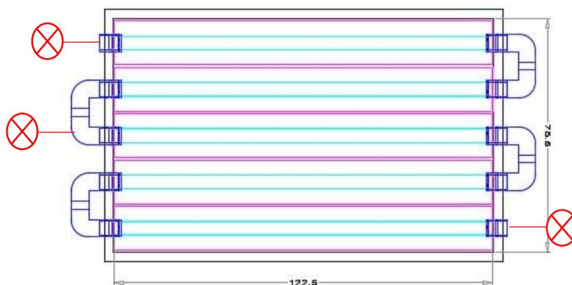
Figura 4.37. Colocación de termómetros, se observan en color rojo.
