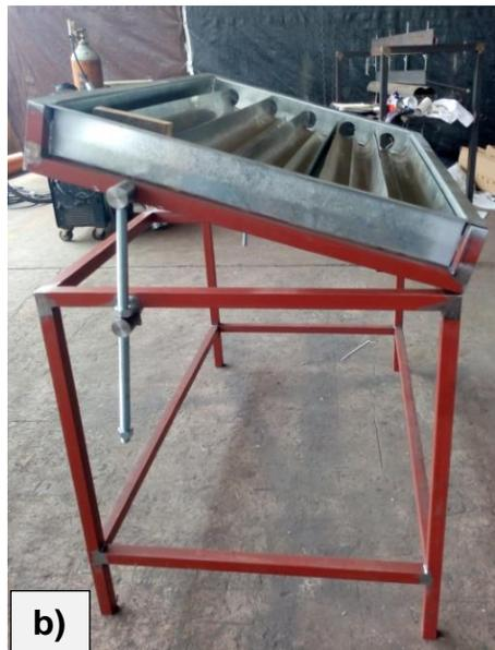
Figura 4.30. Estructura de soporte: a) estructura tubular y b) mecanismo de variación del ángulo.
