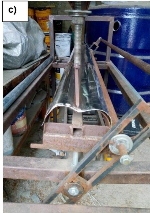
Figura 4.26. Aproximación del perfil: a) se coloca la lámina en la prensa, b) primer dobles, c) curvatura de los canales del CPC.
