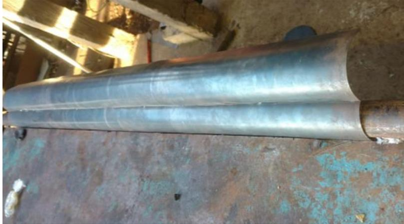
Figura 4.22. Molde base de curvatura.
