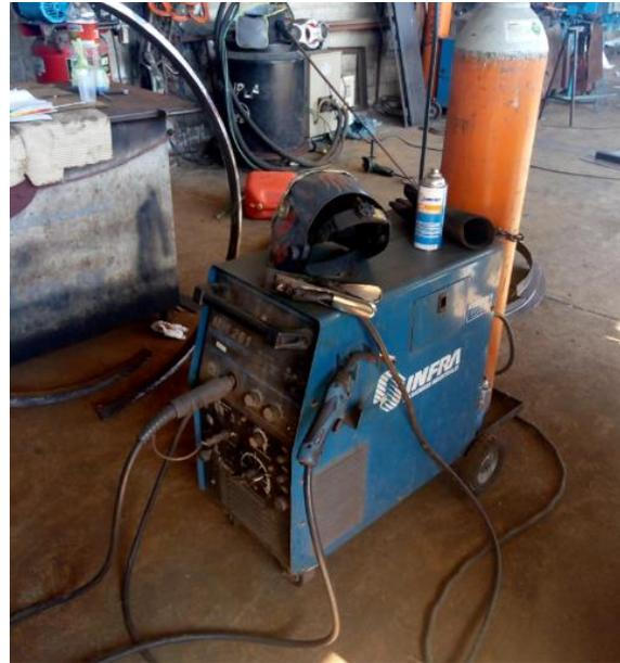
Figura 4.17. Máquina de soldadura.
