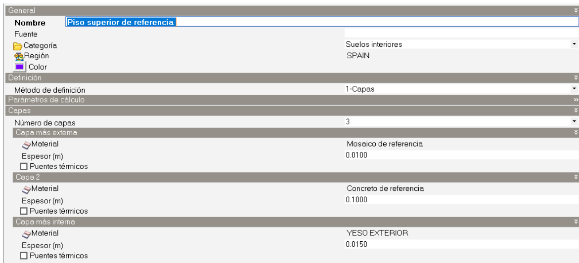
Figura 3.68: Materiales que conforman el piso de la planta alta.
