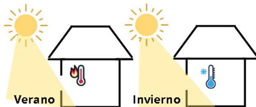
Figura 1.2: Aplicación de la orientación para las ganancias solares por estación del año.
