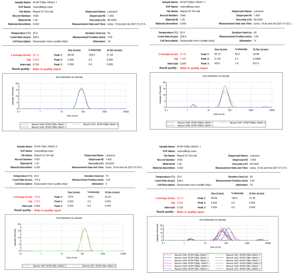
Gráficas 3a - 3d. Determinación de tamaño de gotícula de la formulación F2B mediante Z-sizer.
