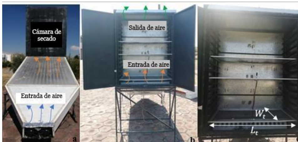
Figura 5.2. Suministro de flujo de aire por dos ventiladores. El aire fluye de forma forzada por los conductos del colector solar hacia el interior de la cámara de secado.
