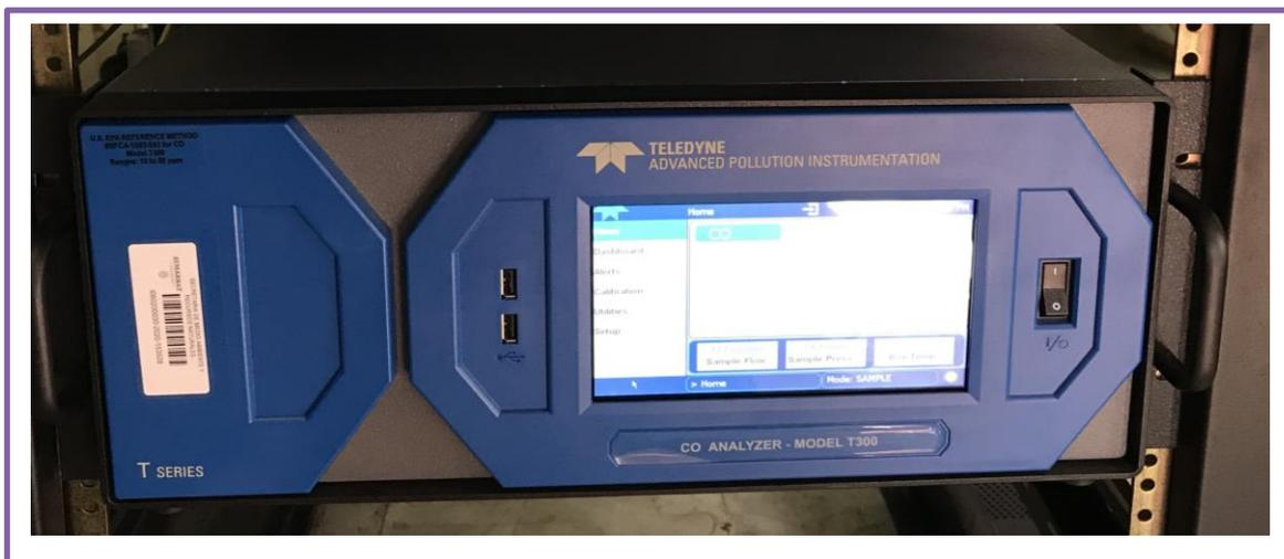
**Figura 2.** Equipo CO Analyzer - Model T300.
