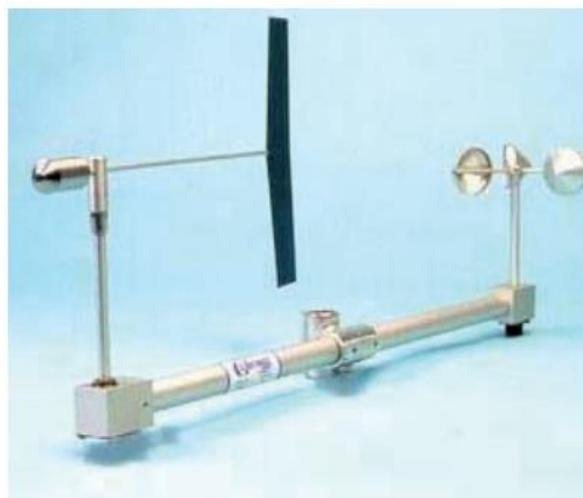
**Figura 6.** Sensor de velocidad del viento. Fuente: Manual 3. Redes, Estaciones y Equipos de Medición de la Calidad del Aire, INECC.
