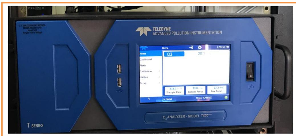
Figura 1. Equipo O<sub>3</sub> Analyzer – Model T400.
