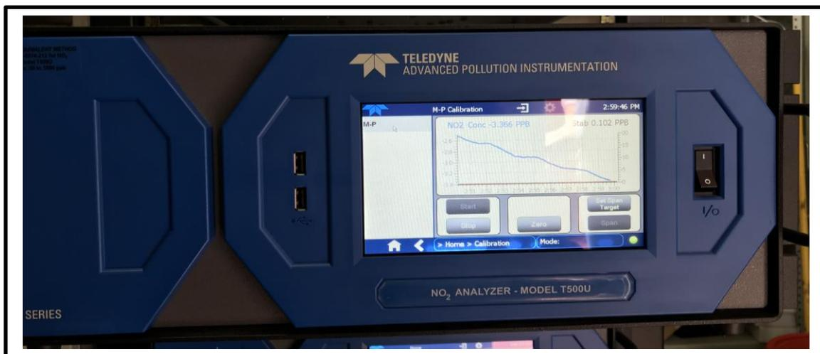
**Figura 3.** Equipo NO<sub>2</sub> Analyzer – Model T500U.
