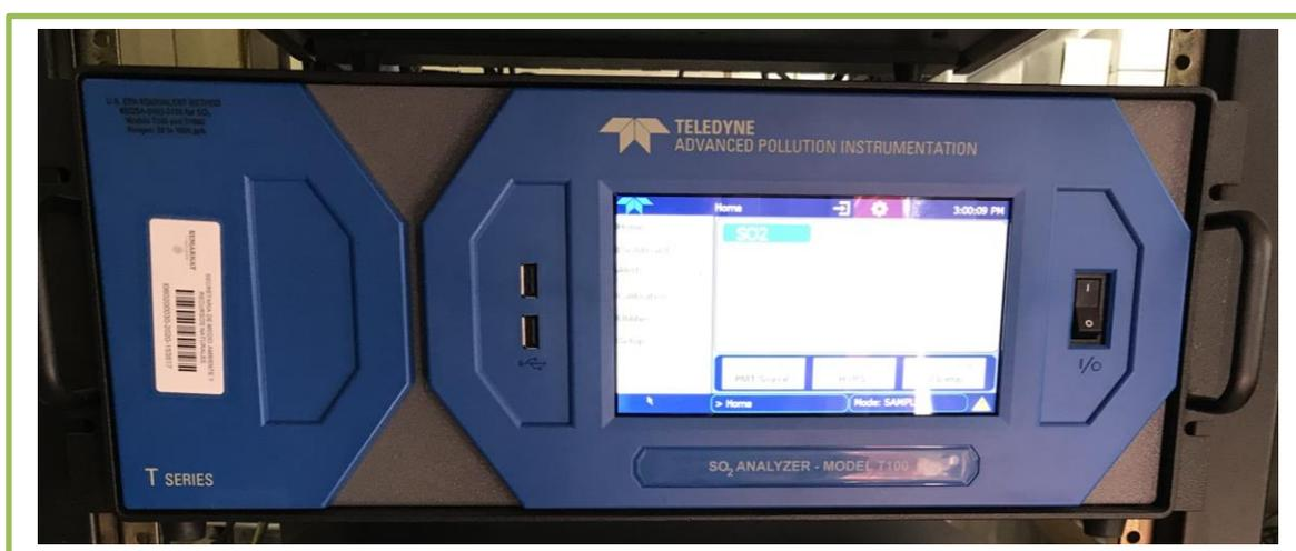
**Figura 4.** Equipo SO<sub>2</sub> Analyzer – Model T100.
