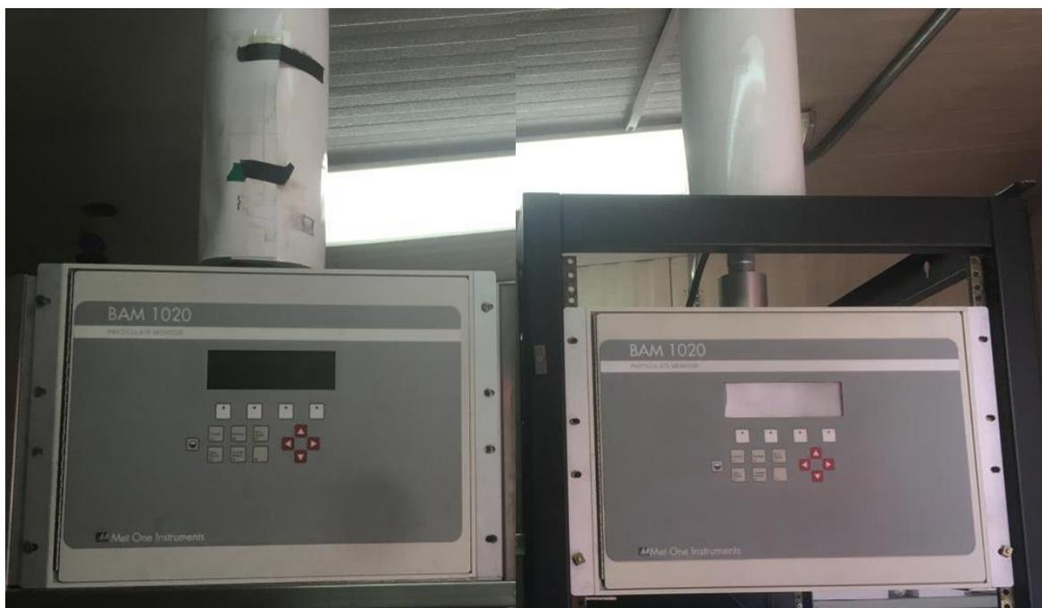
**Figura 5.** Equipos de medición de  $PM_{10}$  y  $PM_{2.5}$  BAM 1020.
