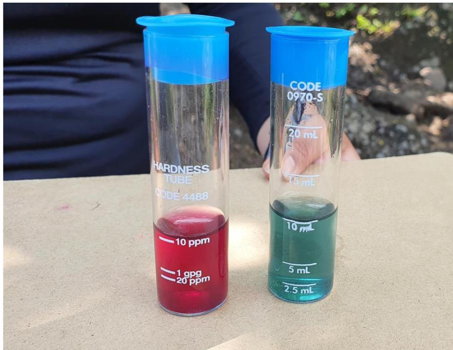
Figura 17. Estimación de alcalinidad
