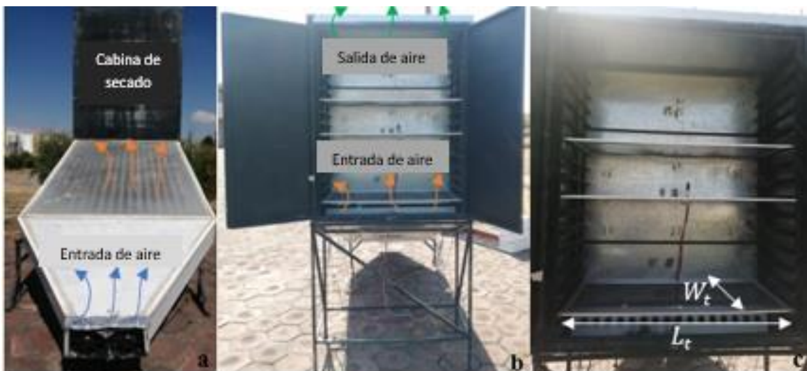
Figura 4. Suministro de flujo de aire por dos ventiladores. El aire fluye de forma forzada por los conductos del colector solar hacia el interior de la cámara de secado
