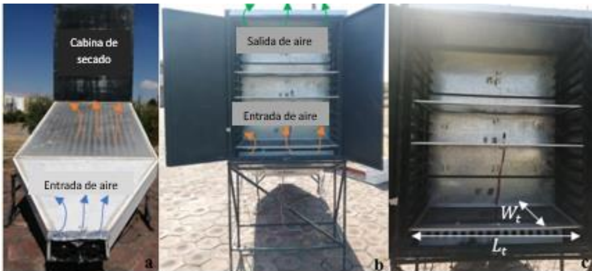
Figura 3. Suministro de flujo de aire por dos ventiladores. El aire fluye de forma forzada por los conductos del colector solar hacia el interior de la cámara de secado.
