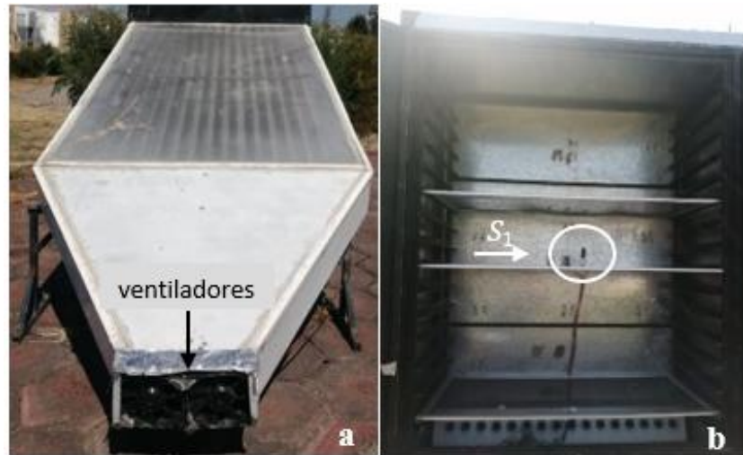
Figura 5. a) Ubicación de ventiladores en el colector solar. b) Ubicación del sensor de temperatura y humedad DHT22 en el centro de la cámara de secado.
