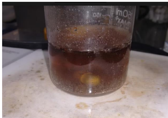
Figura 6. Cambio de coloración en la solución debido a la formación de catecol y benzoquinona.
