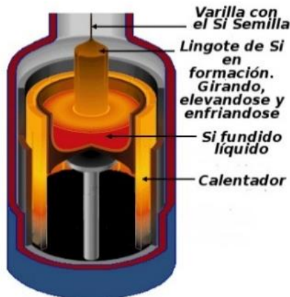
Figura 17. Método de Czochralsky
