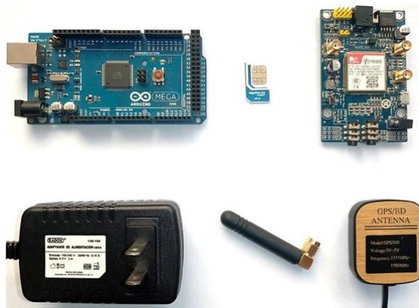
**Figura 4.3:** Componentes de hardware del dispositivo IoT
