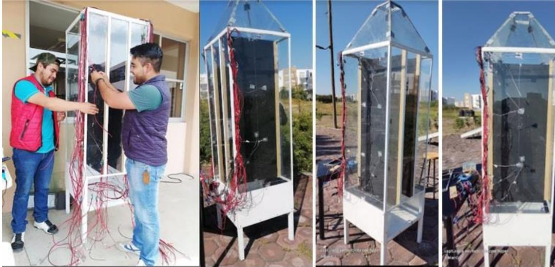
Figura 6.3. Instrumentación de la chimenea solar.
