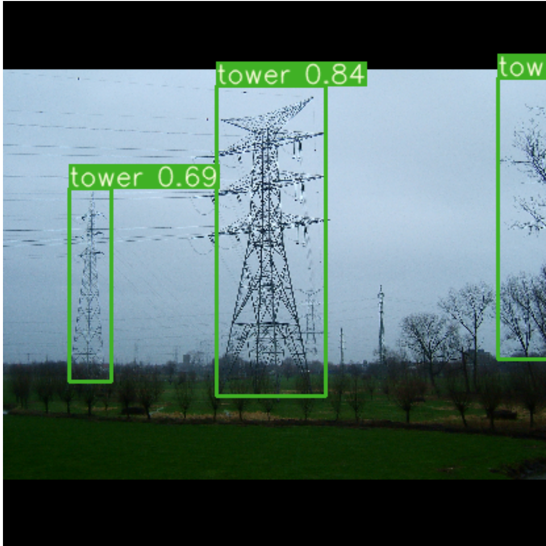
Figura 5.12: Caso real de ramas de árbol confundidas por el modelo como torres eléctricas
