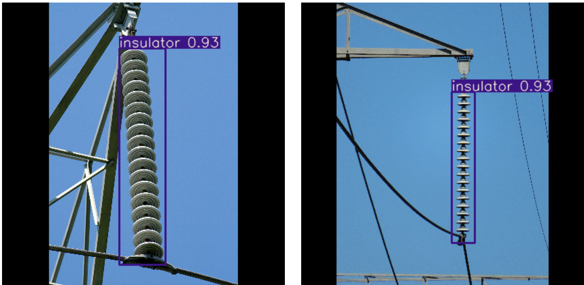
Figura 5.4: Resultado de la detección de cadenas de aisladores eléctricos reales usando YOLOv3
