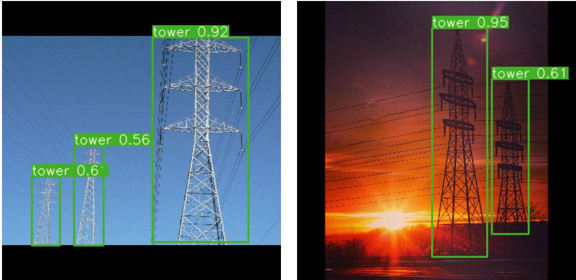
Figura 5.3: Resultado de YOLOv3 en imágenes con diferentes torres eléctricas reales
