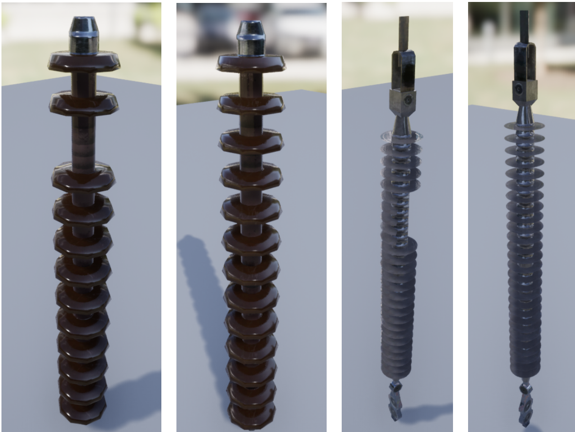
Figura 4.2: De izquierda a derecha: Cadena de aisladores de tipo 1 con y sin fallas. Cadena de aisladores de tipo 2 con y sin fallas.
