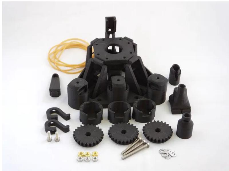
**Figura 4.11.** Microscopio OpenFlexure y sus componentes. Imagen tomada de: [www.hackster.io](http://www.hackster.io)
