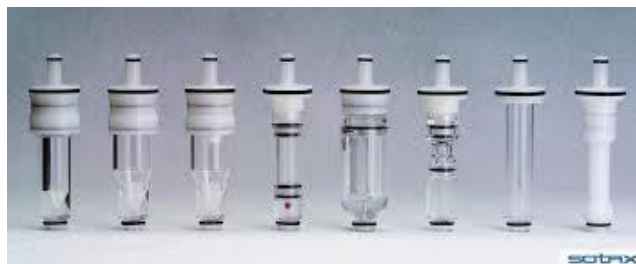
Figura 8. a) Composición del equipo disolutor 4 USP de flujo continuo y b) diferentes celdas de flujo (Badillo Lugo, 2017)
